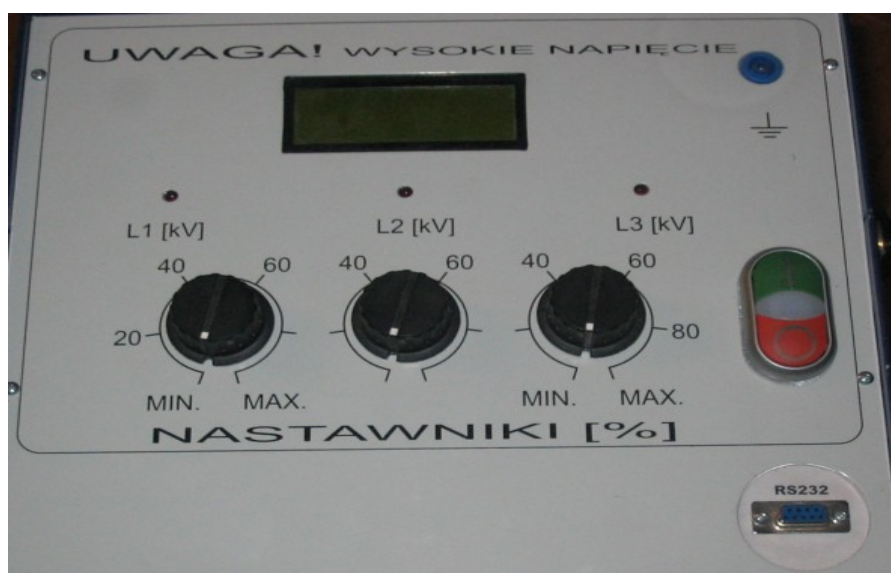
Rysunek 4 Płyta czołowa aparatu EMEX 10kV
