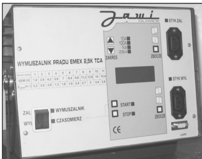
Rysunek 1. Widok płyty czołowej aparatu EMEX 2,5TCA
